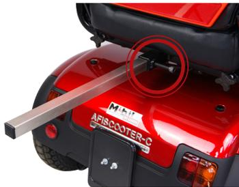
3. Stecken Sie die Edelstahlhalterung mit der Trägerplatte über das Edelstahlträgerrohr
