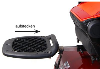
4. Befestigung der Transportbox auf der Trägerplatte mittels Wendelschraube.
